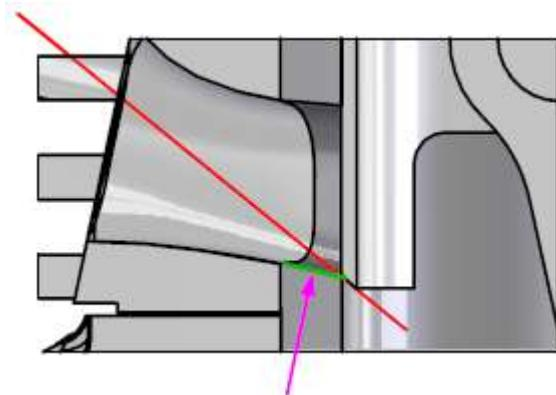
La cale ne suit pas la partie plate de l'orifice d'admission / Wedge does not follow the flat part fo the inlet port
